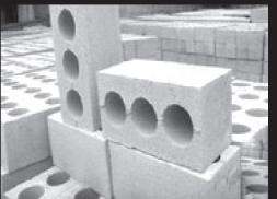
Изготовлен методом вибропрессования
